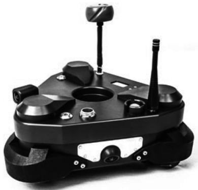
Рис. 4 TRIC (трехколесный инспекционный гусеничный сканер), установленный в дроне AeroX
