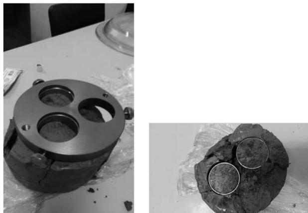
**Рис. 1.** Отбор образцов для испытания методом трехосного сжатия в лаборатории «Механика грунтов».
