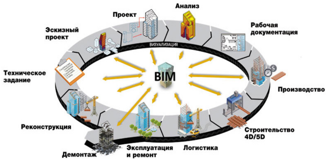
Рис. 2. Применение BIM в жизненном цикле объекта
