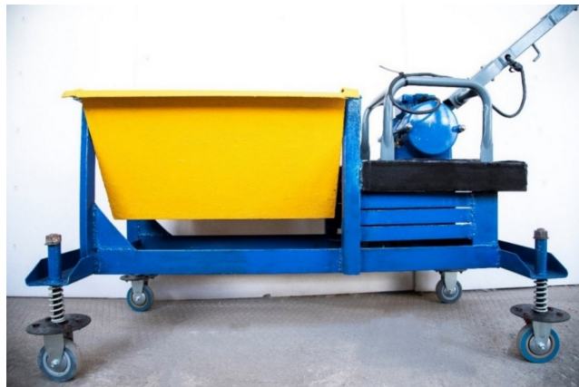
Рис. 4. Общий вид прототипа экспериментальной мобильной установки для бетонирования линейных элементов с направленной ориентацией фибр.
