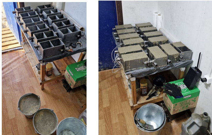
Рис. 4. Процесс подготовки и изготовления кубических образцов
