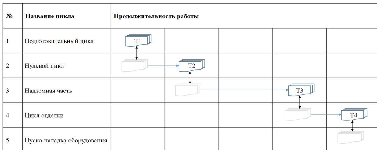
Рисунок 1 – Достижение непрерывности строительного производства посредством параллельного выполнения работ
