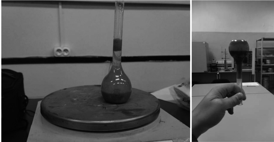
Рис. 3. Процесс проведения испытания на определение плотности грунта пикнометрическим методом
