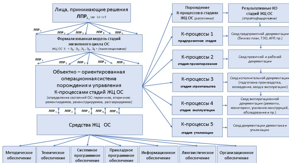
Рис. 2. Схема формализации построения автоматизированных технологий управления жизненным циклом объектов строительства
